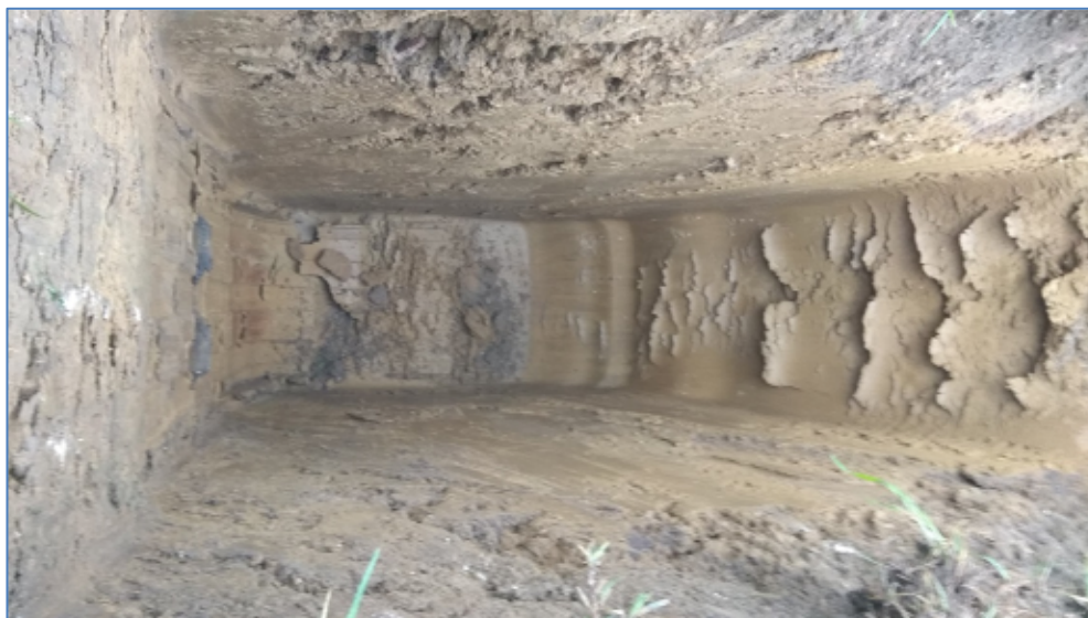
Foto 9: trincea esplorativa effettuata in corrispondenza della verticale D1, che evidenzia la presenza di limi argillo-sabbiosi fino alla profondità di 2.7 m dal p.c.
