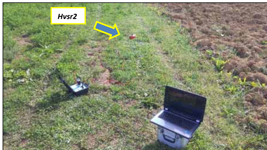
Foto 8: registrazione delle frequenze (Hvsr2) naturali del terreno.
