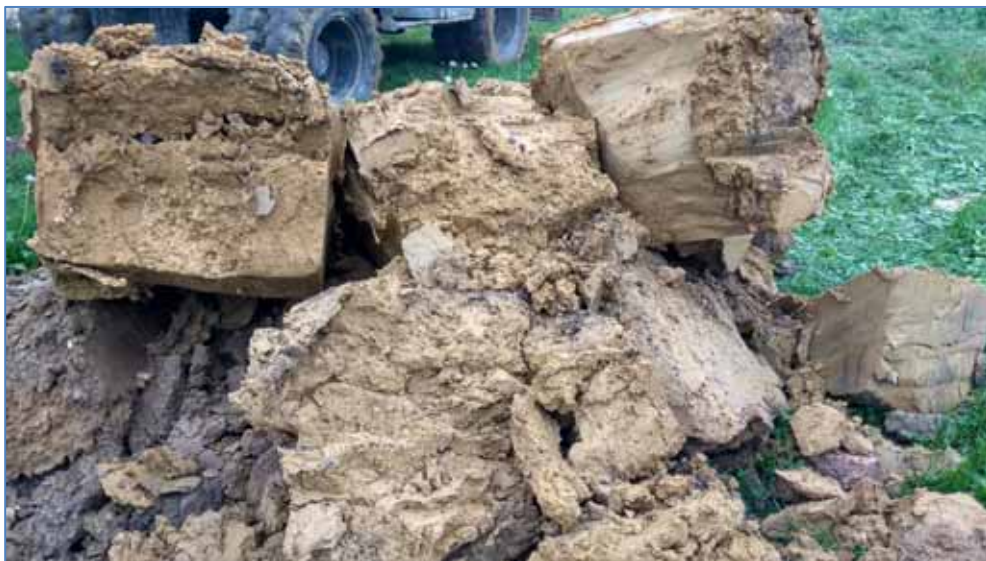
Foto 10: particolare del terreno estratto dalla trincea, dove si osserva la matrice sabbiosa abbondante (ricca di calcinelli).
