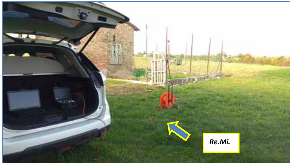
Foto 6: stendimento sismico ai microtremori (Re.Mi.)
