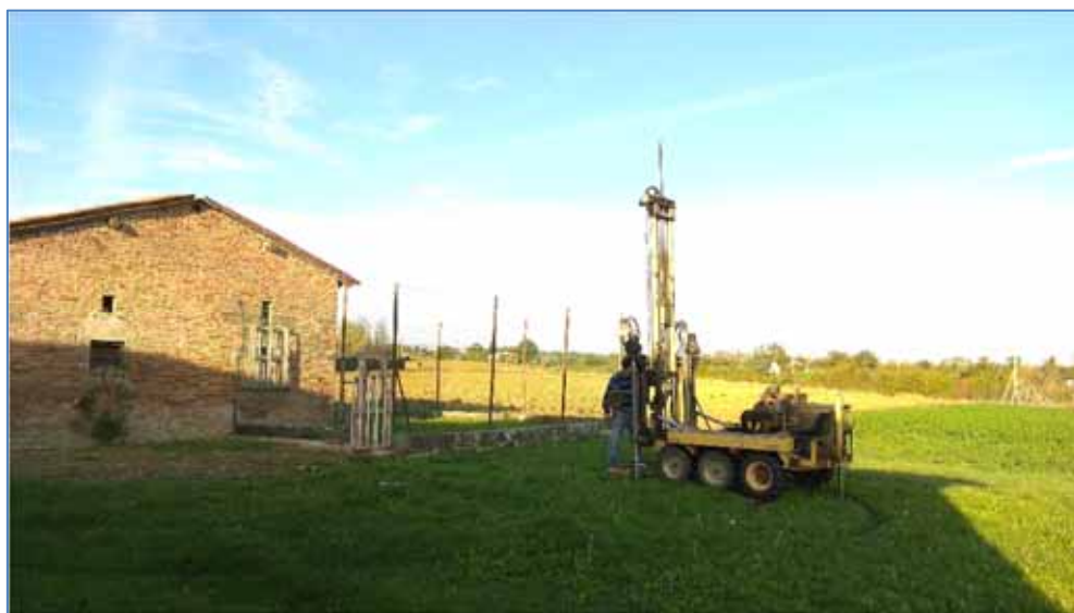
Foto 1: Realizzazione della prova penetrometrica D1
